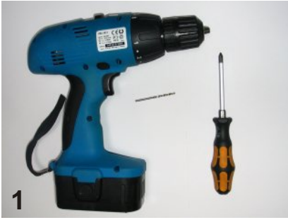
1 Verktyg som behövs vid monteringen. Stjärnmejsel, bormaskin och borr Ø2,5mm
